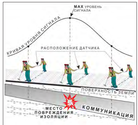
применение датчика-определителя дефектов коммуникации (ДОДК) методом max
